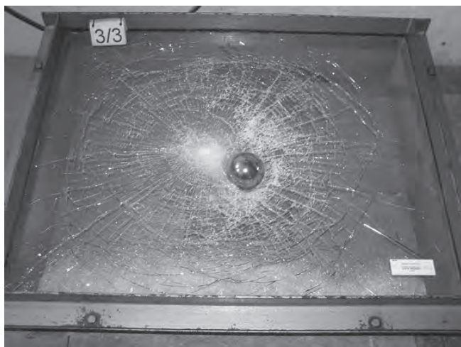
Obr. 1: Zkouška skla odolného proti vandalismu
